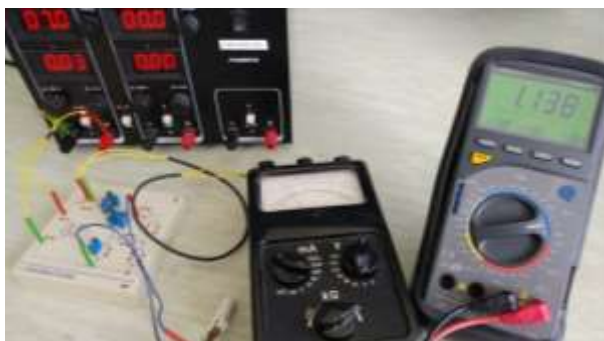
Obrázok 4.1 Meranie na odporovom deliči napätia klasickými meracími prístrojmi
