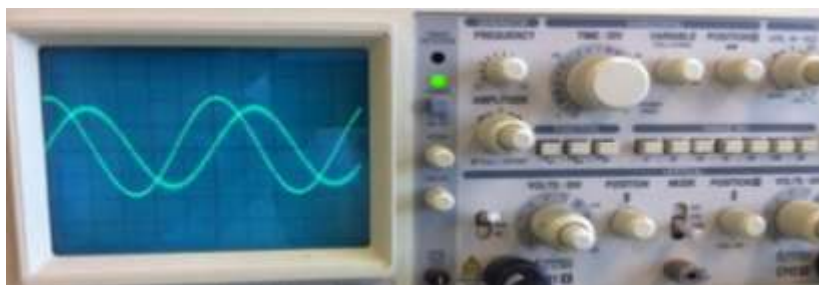
Obrázok 4.4 Meranie výstupného napätia RC filtra osciloskopom
