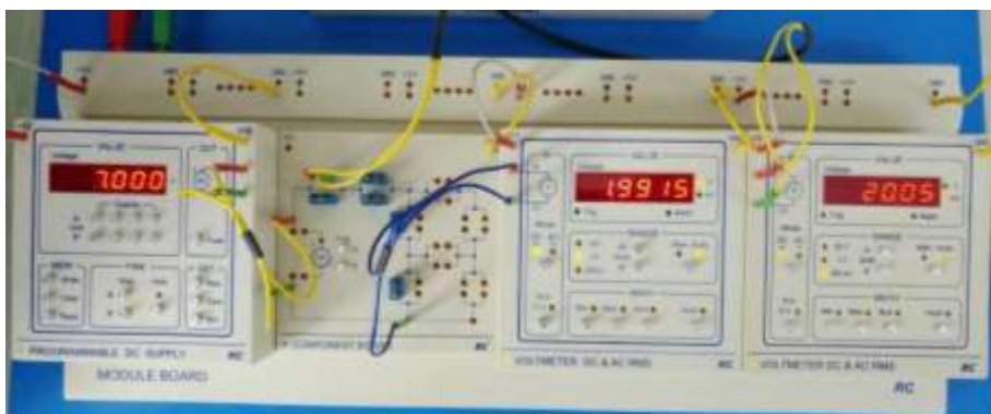
Obrázok 4.2 Meranie na odporovom deliči napätia so systémom rc2000
