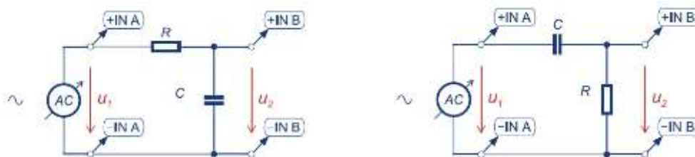
Obrázok 3.20 Schéma zapojenia na meranie RC filtrov systémom rc2000
