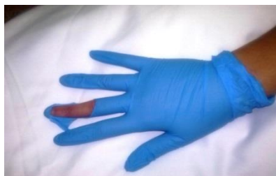
Rys. 15. Głow Tec rękawice nitrylowe. Uszkodzenie przy otwieraniu fioli z lekiem [fot. z badań własnych]
