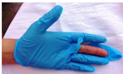
Rys. 18. Głow Tec rękawice nitrylowe. Uszkodzenie przy zmianie pościeli [fot. z badań własnych]
