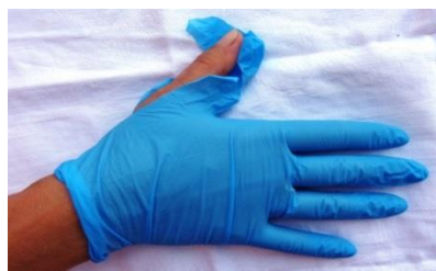
Rys. 19. Głow Tec rękawice nitrylowe. Uszkodzenie przy naciąganiu prześcieradła [fot. z badań własnych]
