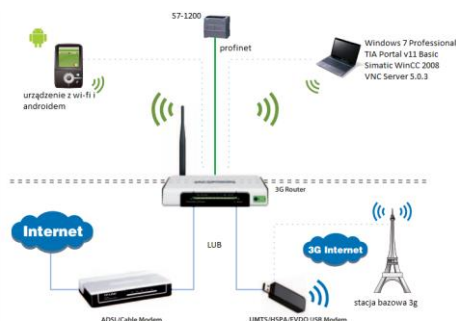
Rys. 21. Schemat ideowy połączenia urządzeń w sieć Ethernet [5]
