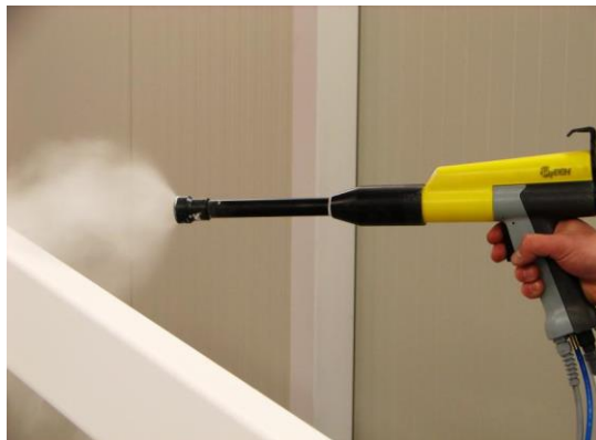
Rys. 6. Ręczny pistolet do malowania proszkowego (opracowanie własne na podstawie [8])
