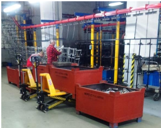
Rys. 7. Pracownicy podczas zawieszania wyrobów na linię malarską
