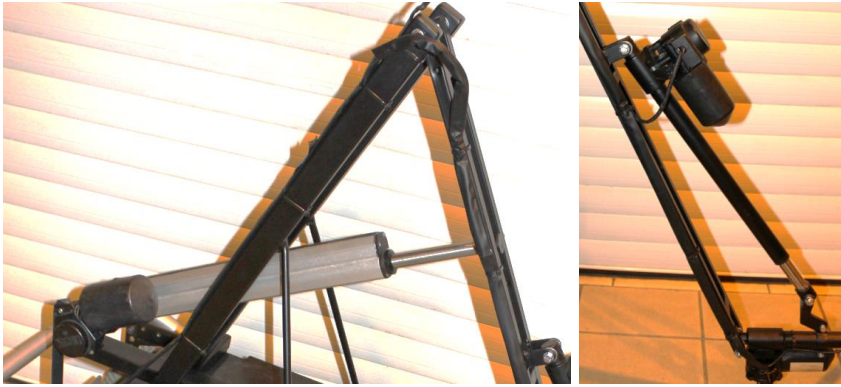
Rys. 7. Siłowniki sterujące położeniem ramienia (lewy) i chwytaka (prawy)
