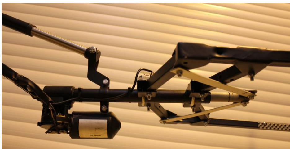
Rys. 12. Widok dolnej części chwytaka i sposobu mocowania go do ramienia
