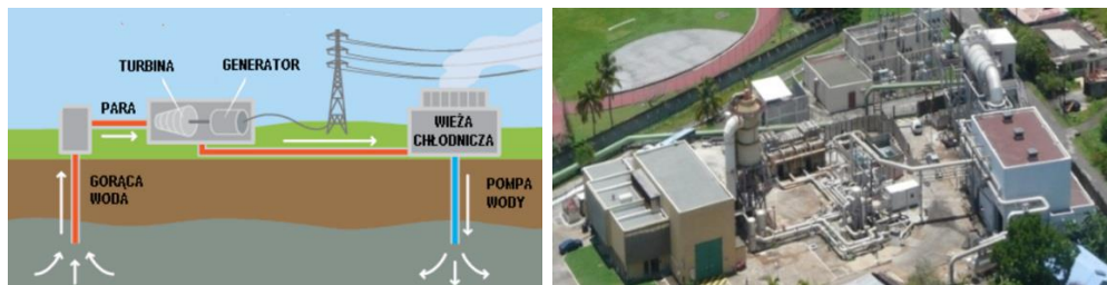
Rys. 8. Schemat działania [38] i widok elektrowni geotermalnej w Bouillante [39]
